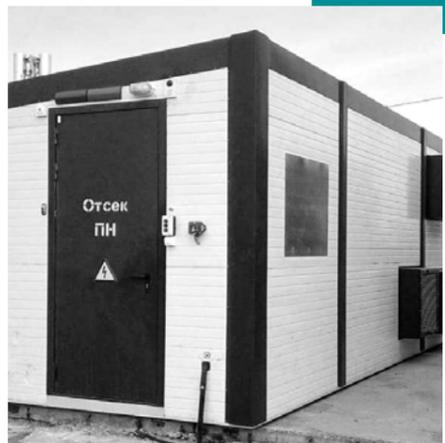
**Система накопления электрической энергии напряжением 0,4 кВ, мощностью 100 кВА, энергоёмкостью 200 кВт·ч**
